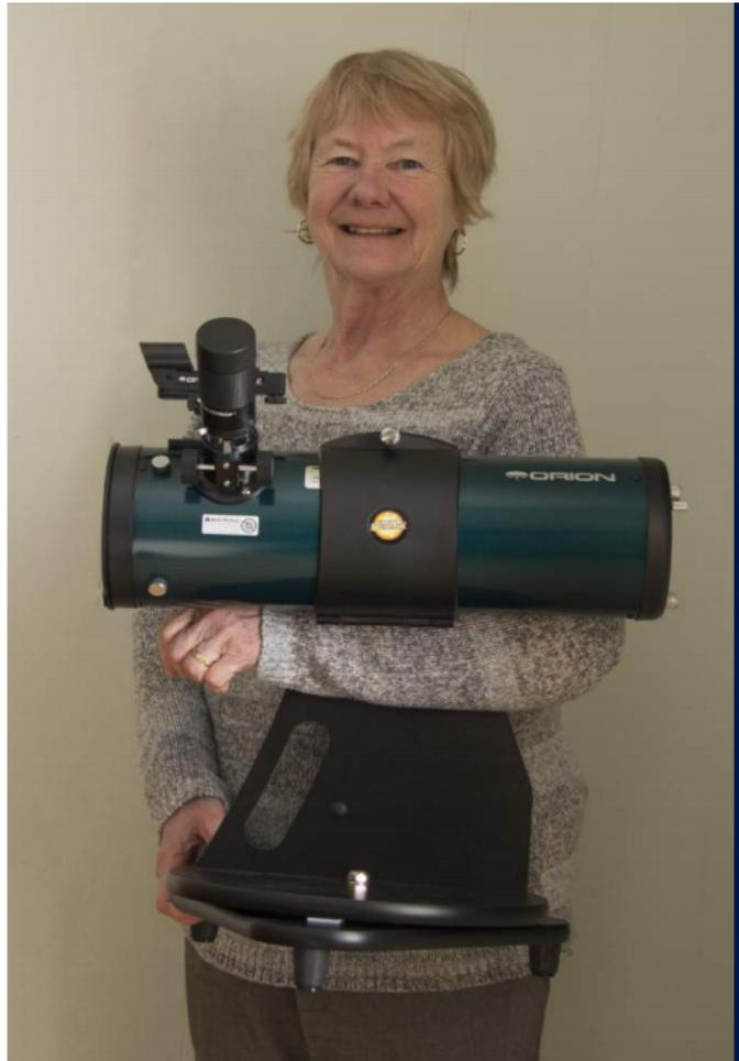
Appuyez le télescope sur l'avant-bras et supportez la base avec l'autre main.
